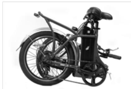
Для сборки электровелосипеда необходимо выполнить действия в обратном порядке. При этом необходимо убедиться в надежном закреплении фиксаторов механизмов складывания.
